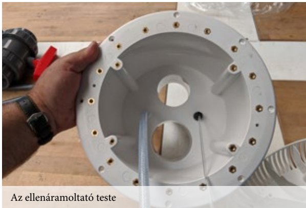
A kapcsolótömlő kivezetése az ellenáramoltató testből a szűkítőn keresztül a védőtömlőbe
